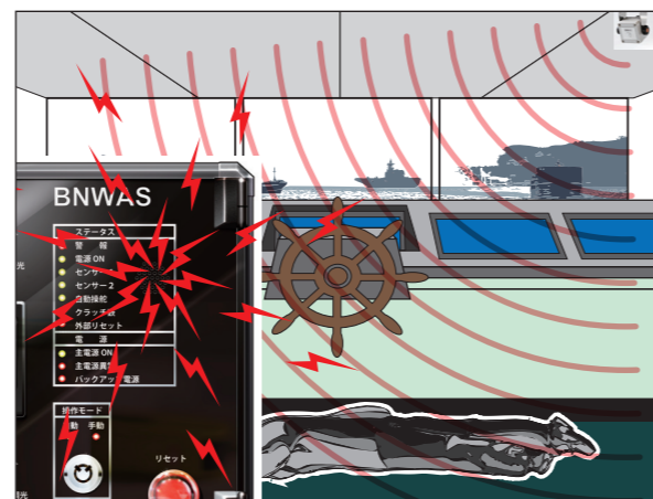
操縦室は勿論、ウイングやスタッフルーム等に設置した警報ブザーで異常を通知
